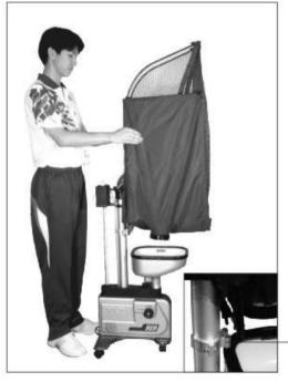
4、將發球機移至球臺邊緣, 移動時應把脚輪鎖緊器打開。
