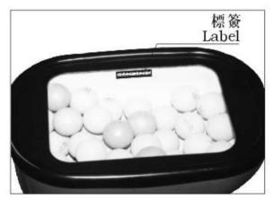
儲球器裝40mm球約100個。放球時 不能超過儲球器內側標簽所示黃綫位, 不能將其它雜物也倒入儲球器內,否 則會損壞機內零件,并影響發球機的 正常工作。
