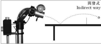
發球機的發球形式分爲直發式和問發式,直發 式發出的球速度和旋轉都比問發式稍强,調整時通 過弧度調節旋釦進行。
